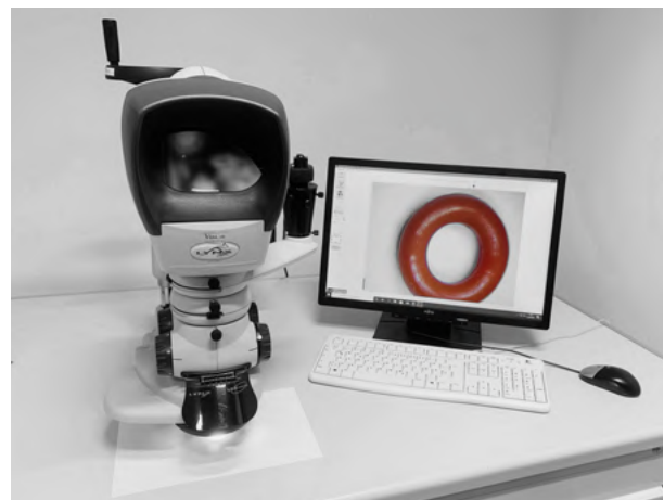
用数码显微镜进行表面检查
