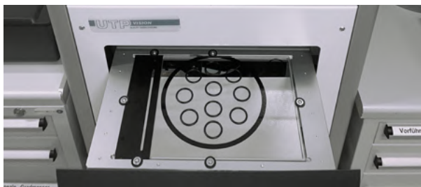
使用光学测量机进行非接触尺寸检查
